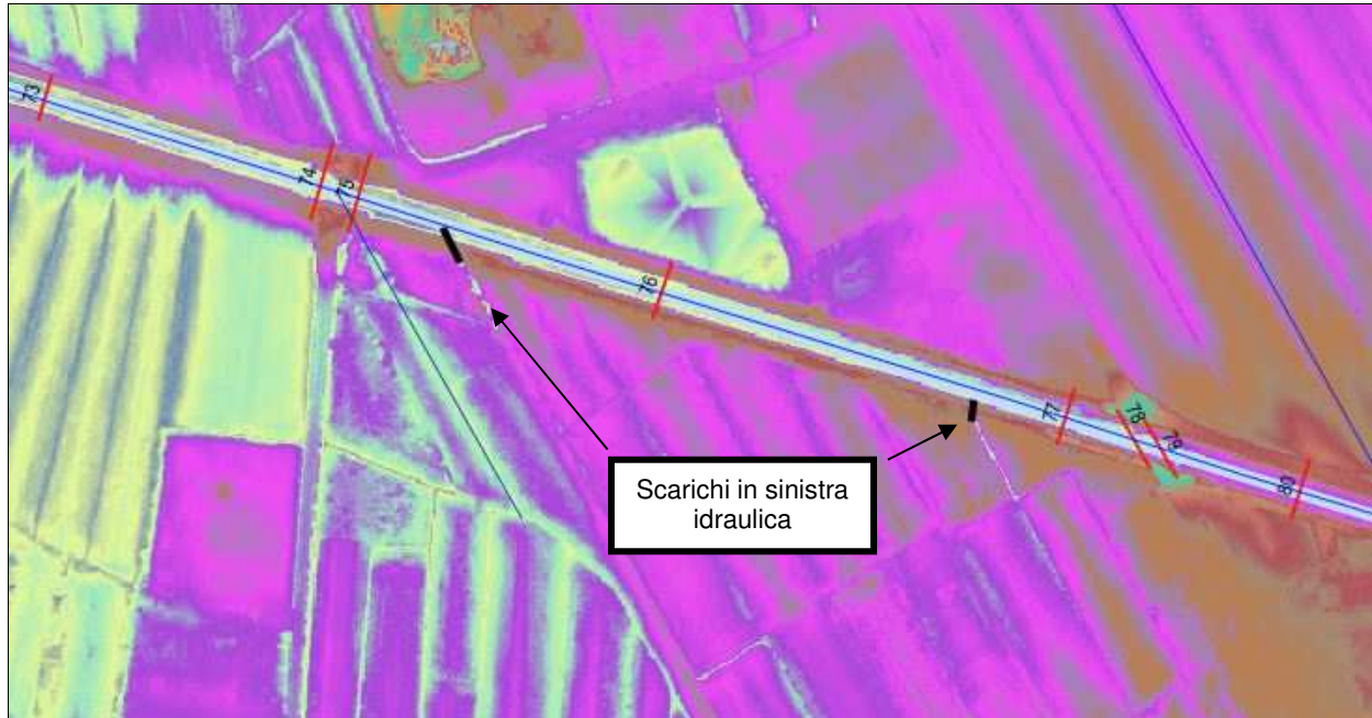
Fig. 59 – Particolare degli scarichi in sinistra idraulica del Rio di Fucecchio nel tratto terminale del modello
