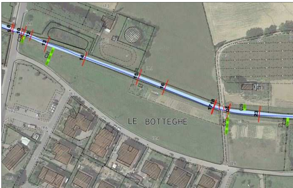
Fig. 30 – Particolare dei tombini presenti lungo il Rio di Vallebuia nel tratto a monte della SR 436.
