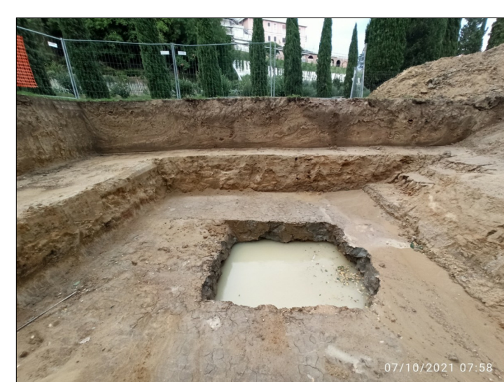
F.13. Panoramica del Saggio S11 che ha interrotto in superficie le sabbie dello strato S1, e verso il fondo le argille dello strato S0.
