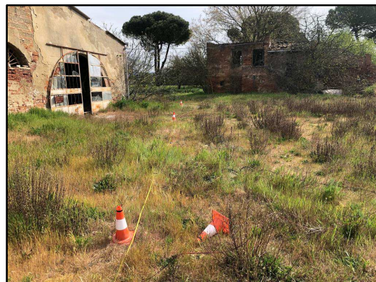
Stesa sismica Onde P/SH (Lato NE)
