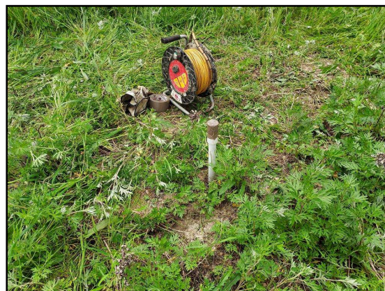
Completamento (Piezometro) Prova PS.2
