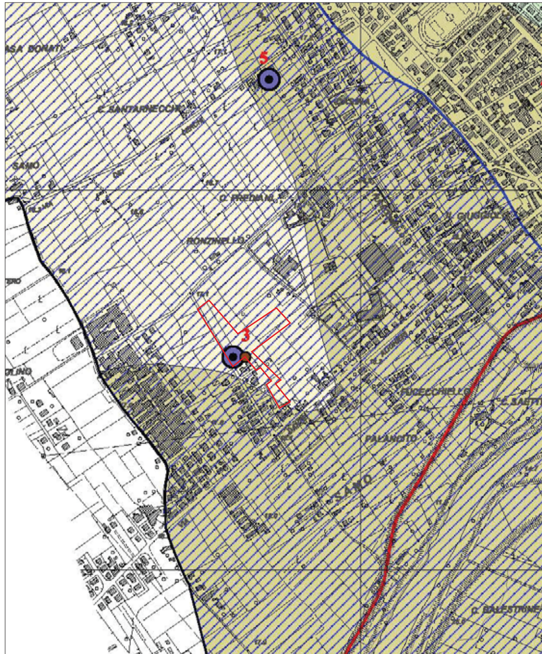
FIGURA 8: Stralcio della Carta delle Microzone Omogenee in Prospettiva Sismica e delle frequenze fondamentali ai sensi del D.P.G.R. 53/R-2011 (Tratto dal R.U. Comunale)
